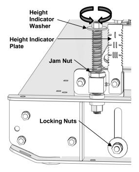
HEIGHT ADJUSTER ON OUTER ENDS OF DECKS (12) PLACES
